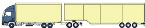
Typ 3: Lastkraftwagen mit Untersetzachse und Sattelanhänger bis zu einer Gesamtlänge von 25,25 Metern
